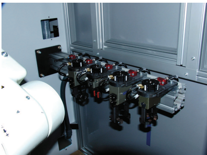
7. Alloggiamento delle cinque diverse pinze di afferraggio sostituibili in automatico.
